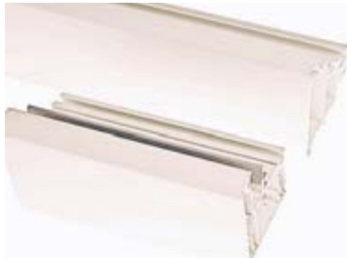
Fensterprofile aus Kunststoff werden heute nach dem Extrudiervorgang mit beheizten Messern leise, spanfrei und sauber geschnitten.
